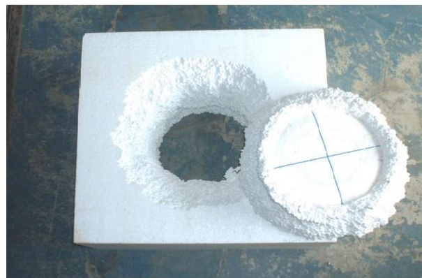
EPS受集中荷重之破壞形式(1/2)
