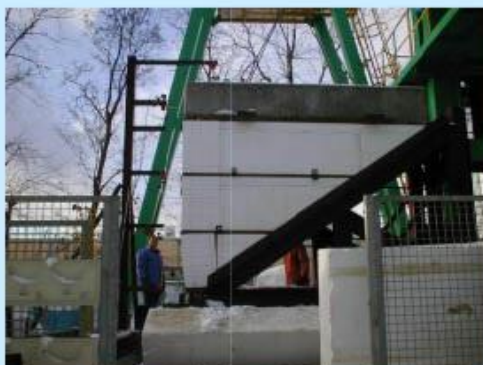
拓寬填土振動台實驗
