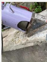
施加最大拉力至設計拉力
