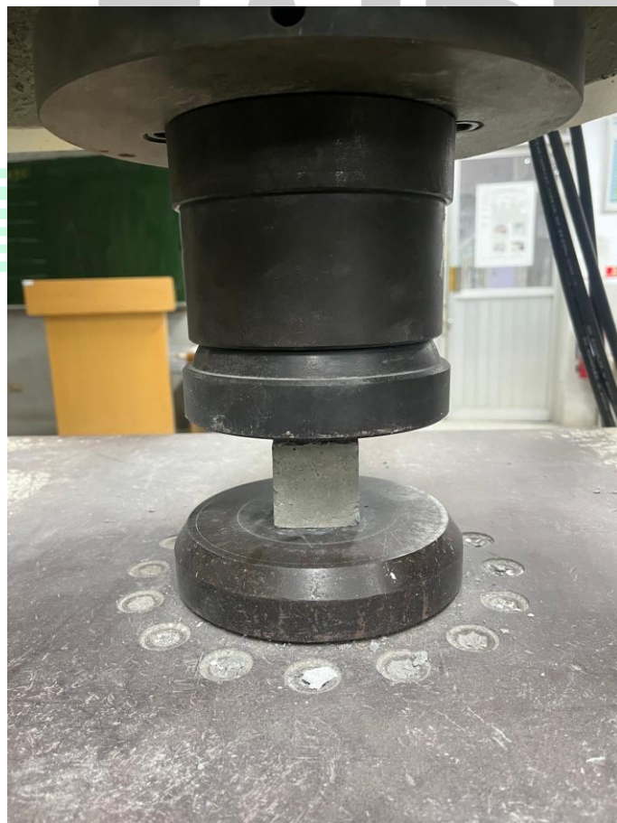
圖 3.22 抗壓強度試驗
