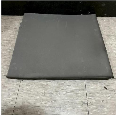
圖 3.12 厚度 15mm PE 隔音墊
