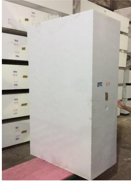
圖 2.5 EPS 成型 (Molding) 塊體
