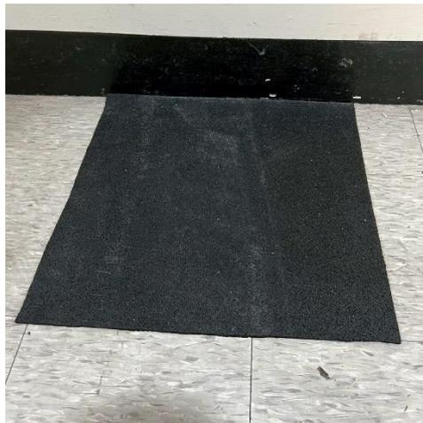
圖 3.11 厚度 5mm 橡膠隔音墊
