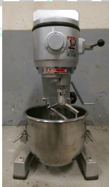
圖 3.21 水泥漿拌合機
