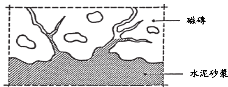
圖 2.7 面磚與黏結材料之機械咬合示意圖
